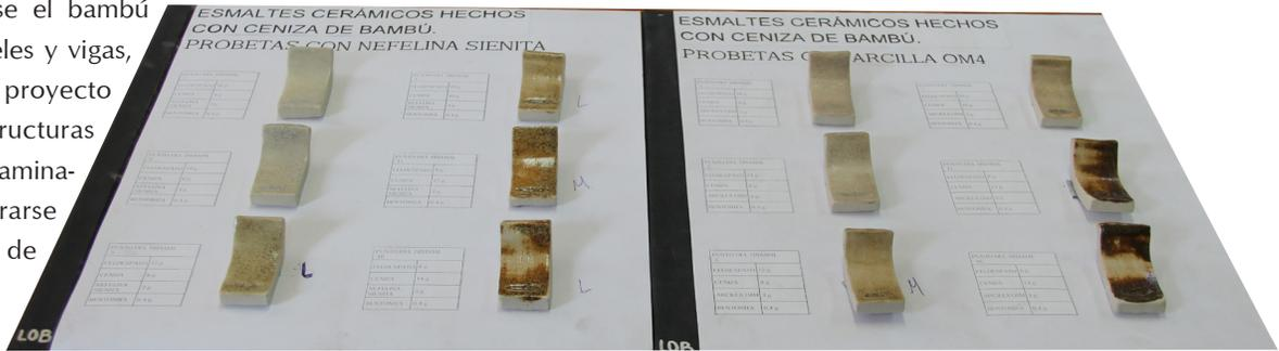
fase de pruebas en azulejos con esmalte de ceniza de bambú; es algo innovador y sustentable, pues usamos el desperdicio de una planta que se reproduce continuamente.
